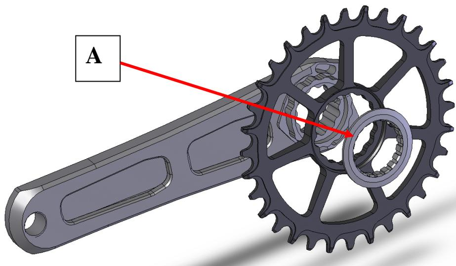
Détrompeur, à placer derrière la manivelle.
