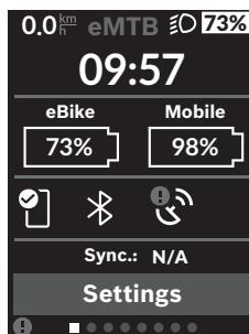
I statusskjermbildet vises statuslinjen, og i tillegg gjeldende klokkeslett, ladenvåret til alle batteriene til eBike og smarttelefonbatteriet hvis smarttelefonen er koblet til via Bluetooth®.
