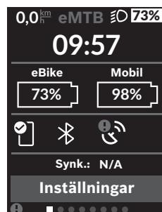
På statusskärmen visas bredvid statusraden även aktuellt klockslag, laddningsnivå för alla batterier på din eBike samt laddningsnivå för din smarttelefon, om den är ansluten via Bluetooth®.
