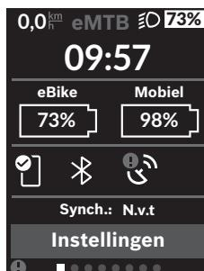
Op het statusscherm krijgt u naast de statusbalk de actuele tijd, de laadtoestand van alle accu's van uw eBike en de laadtoestand van uw smartphone-accu te zien, als de smartphone via Bluetooth® is verbonden.
