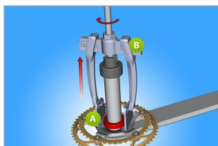
Pour enlever les roulements de la manivelle, utiliser l'extracteur universel (B) en conjonction avec la rallonge correspondante (A).
