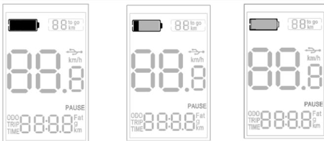
Affichage de la batterie haute      Affichage de la batterie faible      sous tension
